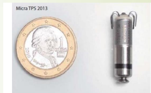
Micra TPS ( Micra Transcatheter Pacing System) stimulační režim : VVI/VVIR hmotnost 2g rozměr : 25,9x6,6mm průměr 23F (2)
